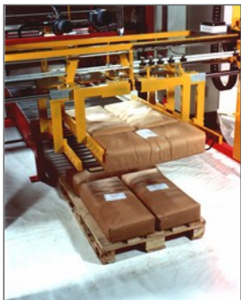
Packlage wird von Hubeinheit auf Palette abgesetzt.
