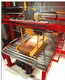
Positioniereinheit umgreift Sackware zum Ausrichten und Drehen.
