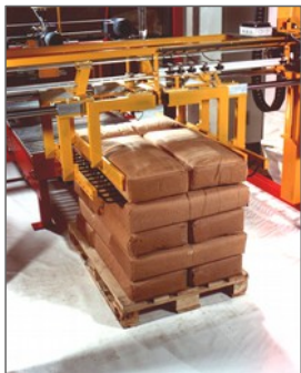
Zinken werden unter Packlage Herausgezogen. Hubeinheit fixiert weiterhin.
