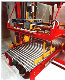
Grundstellung der Positioniereinheit. Packstück kann zugeführt werden.
