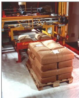
Palette kann mittels Hubwagen oder optional durch Palettenwechsler abgeführt werden.
